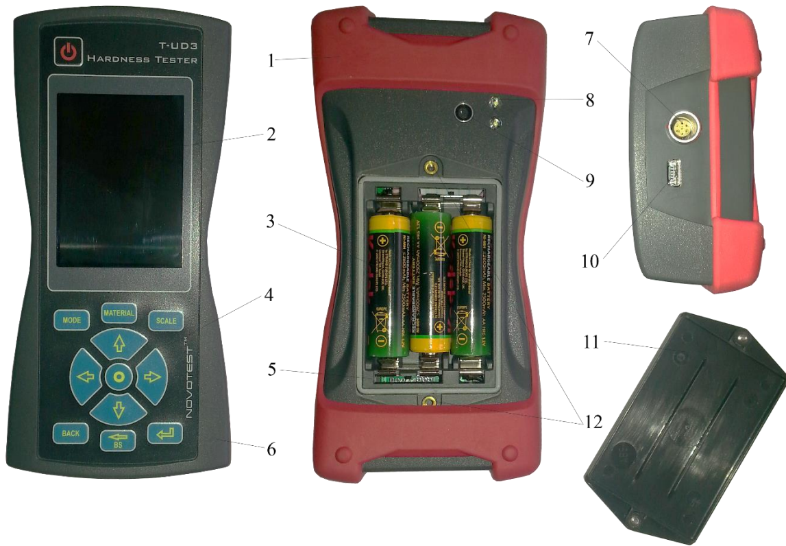
1 – etui; 2 – kolorowy wyświetlacz kontrastowy LCD/TFT; 3 – akumulator NiMH; 4 – klawiatura sterująca; 5 – komora baterii; 6 – jednostka elektroniczna; 7 – gniazdo sondy; 8 – lampa błyskowa; 9 – aparat fotograficzny; 10 – gniazdo miniUSB; 11 – pokrywa; 12 – króćce gwintowe do pokrywy.
